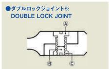
※連結媒体CをマイナスネジAで締めつけることによってジョイント部を一体化し、さらに、ネジBを六角レンチで締めつけ、その底部をマイナスネジAの底部に圧接することによってマイナスネジAをロック状態にする独自の新方式、それが「ジョイント部に緩みのこない」ダブルロックジョイント方式です。
